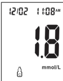
5) 解读质控结果：如系统正常，质控结果应在试纸筒标签上印的质控液的许可范围内。
