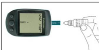
4) 仪器会自动识别质控液并检测，倒计时结束后质控液检测结果显示在屏幕上，并有质控液标识
